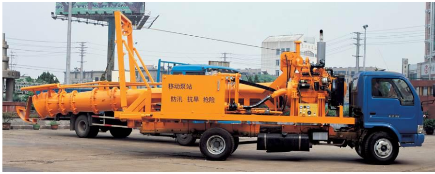
移动式液压抽水泵站
